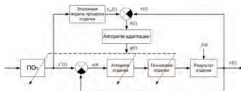
Рисунок 4. Схема адаптивного управления процессом отделки
