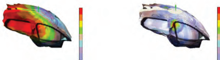
Рисунок 8. Частотный анализ (500Гц) с сферическим бимформингом (слева) и ESM (справа) на - 6дБ.
