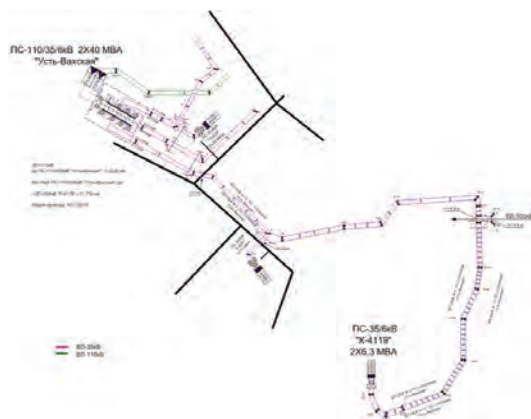
Рис.1 Нормальная однолинейная схема электрических соединений ВЛ - 35кВ Ф - 3,13 ПС - 110 / 35 / 6кВ «Усть - Вахская»
