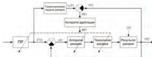
Рисунок 1. Схема адаптивного управления процессом раскроя материала
