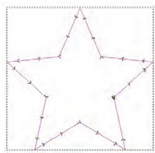
Рисунок 3 – Направление лазерной обработки по заданному вектору
