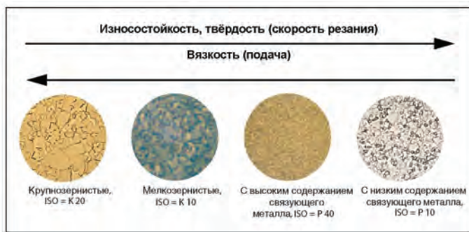
Рис. 2. Микроструктура твёрдых сплавов различных марок.
