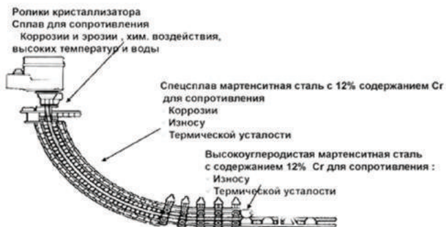
Рисунок 1 – Схема установки непрерывной разливки стали
