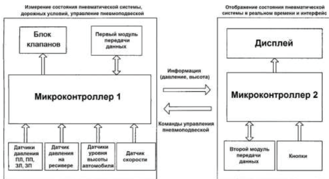
Рисунок 2. Микропроцессорная система управления пневмоподвеской
