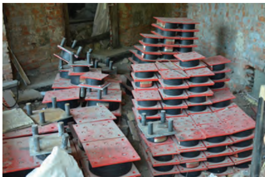
Рис 2. Резинометаллические опоры до монтажа
