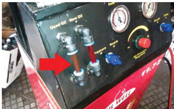
Рисунок 4. Индикаторы потока свежей и отработанной жидкости АКПП
