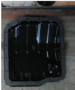
Рисунок 1. Поддон АКПП очищенный от продуктов износа, готовый к установке.
