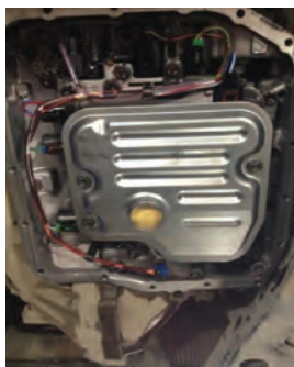
Рисунок 2. Замененный фильтрующий элемент АКПП
