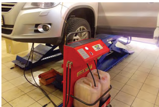
Рисунок 3. Подключенный аппарат по замене жидкости АКПП
