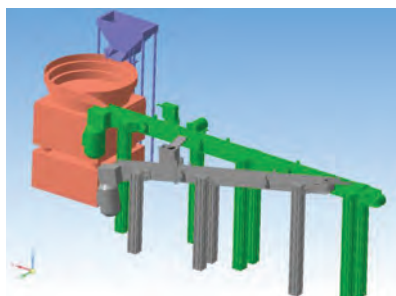
Рисунок 1 – Общий вид модели конвейерной линии по наклейке стикеров в САПР КОМПАС - 3D: Бункерно - загрузочное устройство, Вибробункерная установка, Конвейерная линия основного потока, Конвейерная линия дополнительного потока.
