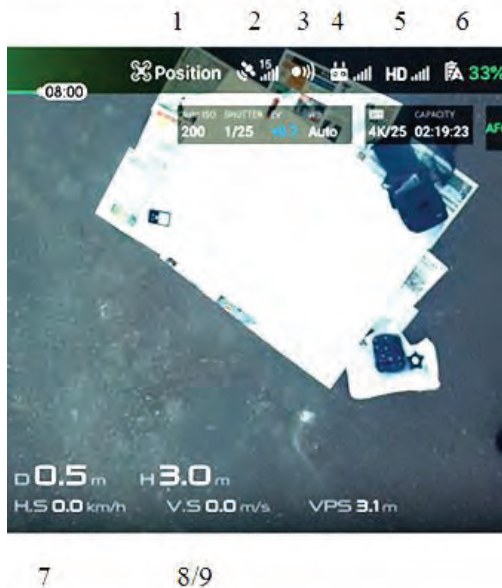
Рисунок 9. Фрагмент экрана пульта управления МПП : 1 – статус соединения (GPS / Глонасс); 2 – мощность сигнала и количество видимых спутников (15); 3 – состояние визуальных сенсоров; 4 – наличие связи сигналов пульта с дроном; 5 – качество передаваемого изображения; 6 – заряд батарей (33 %); 7 – (нижний ряд) –горизонтальная скорость на старте; 8 – (верхний ряд) – высота коптера над землей (3 м); 9 – (нижний ряд) – вертикальная скорость на старте
