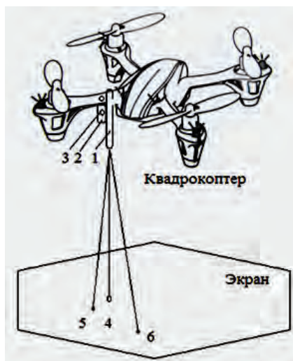
Рисунок 2. Квадрокоптер с лазерным источником (режим «зависания»): 1 – полупроводниковый лазер с аккумуляторами; 2, 3 – детали крепления; 4 - 6 – изображения лазерного луча на экране
