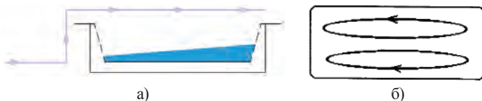
Рисунок 2. Форма перекоса (а) и циркуляции (б) катодного металла на ваннах с односторонним токоподводом [6].
