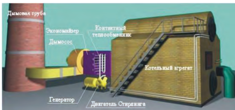
Рисунок 1. Пример применения преобразование теплоты уходящих дымовых газов с двигателем Стирлинга
