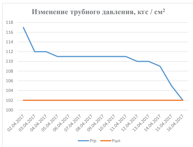
Рисунок 4.2 Динамика изменения трубного давления во времени после процедуры обработки забоя скважины твердыми ПАВ
