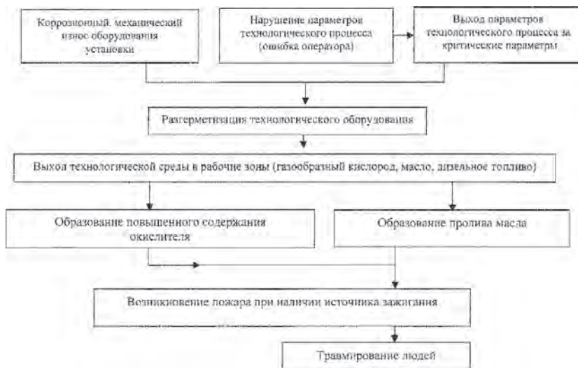
Рисунок 1. Схема построения сценариев возникновения и развития аварийных ситуаций на установке получения газообразного кислорода
