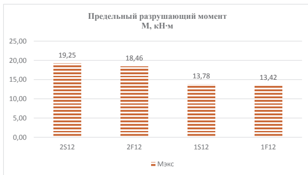
Рисунок 2. Сопоставление предельного разрушающего момента опытных балок
