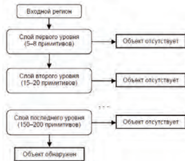
Рис. 2. Пример каскадной модели сильных классификаторов
