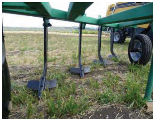
Рисунок 2. - Плуг - рыхлитель ПБС(Ч) - 5М
