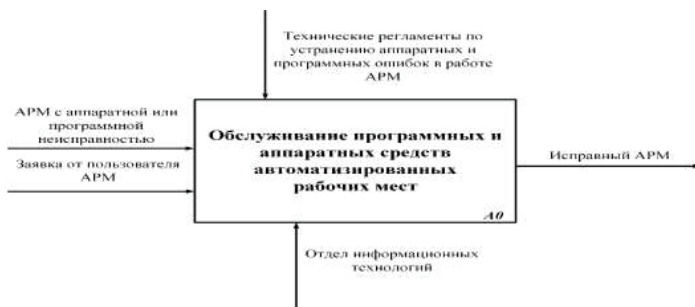
Рис.1. Контекстная диаграмма главной функции «Обслуживание программных и аппаратных средств автоматизированных рабочих мест»
