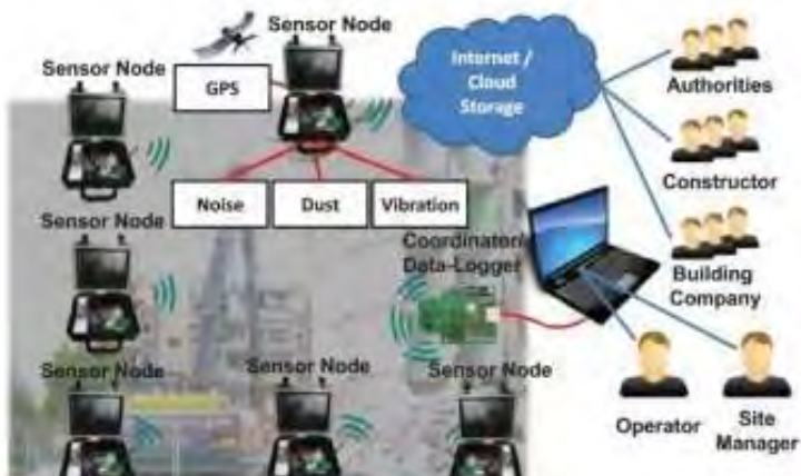
Рисунок 1– Мониторинг выбросов вредных веществ на строительной площадке
