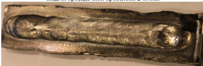
Рисунок 2 – Внешний вид наплавленного валика с подогревом со скоростью подачи присадочной проволоки 6 м/мин
