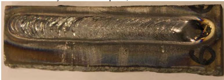
Рисунок 1 – Внешний вид наплавленного валика с подогревом со скоростью подачи присадочной проволоки 2 м/мин
