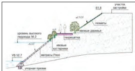
Рис. 7. Схема комплексного биоинженерного метода крепления берегового откоса.
