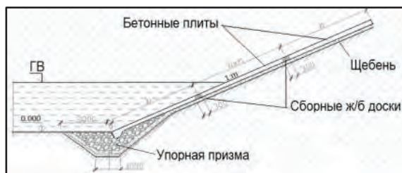
Рис. 2. Схема укрепления берегового откоса бетонными плитами.
