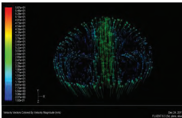
Рис. 1. Распределение скоростей в поперечном сечении отводящего ствола на отметке 15 метров
