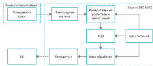
Рисунок 1 – Функциональная схема БТС МИО
