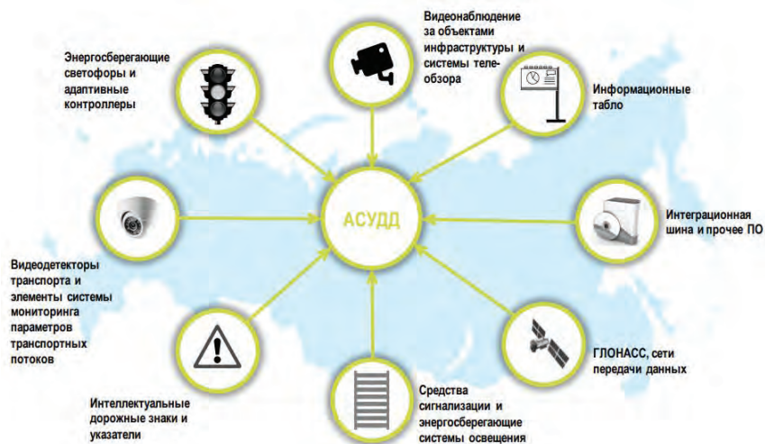
Рис. 1. Компоненты автоматизированной системы управления дорожным движением
