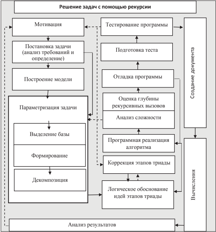
Рис. 1 Схема решения задач с помощью рекурсии
