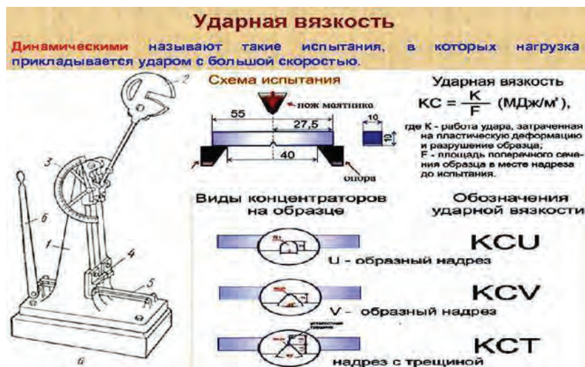
Рис.1. Машина для испытаний на ударную вязкость
