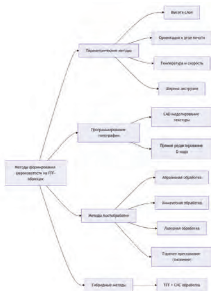
Рис. 1. Методы формирования шероховатости на полимерных образцах, полученных методом FFF - печати
