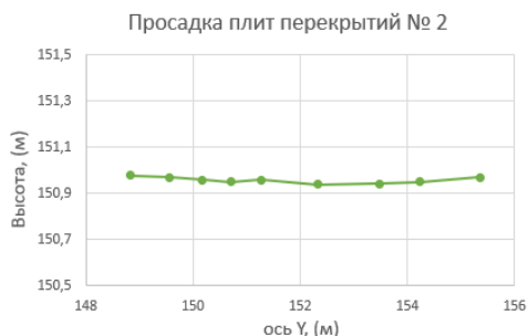
Рисунок 2. Диаграмма крена просадки плиты перекрытия № 2
