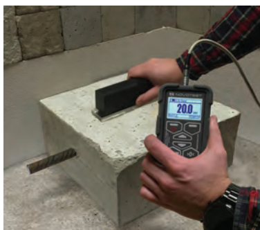
Рисунок 2. Пример применения прибора для измерения защитного слоя бетона до стержня арматуры
