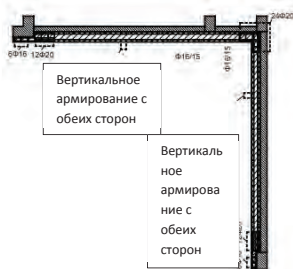
Рисунок 2 – Укрепление стен первого этажа
