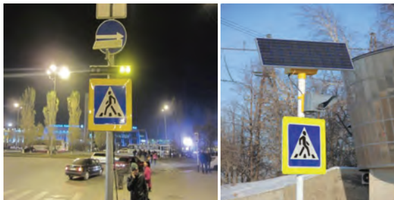
Рисунок 4 – Пешеходный переход, работающий на солнечных панелях
