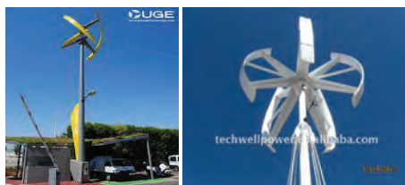
Рисунок 6 – Вихревые вертикальные ветрогенераторы фирмы UrbanGreenEnergy (слева) и Techwellpower (справа)
