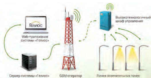
Рис. 2 Общая схема работы АСУНО «Гелиос»
