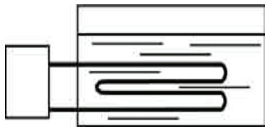
Рисунок 6 - Устройство для непрямого подогрева реактора
