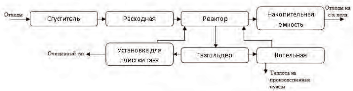
Рисунок 2 - Схема энергокомплекса с биогазовой установкой для средних и крупных сельскохозяйственных предприятий
