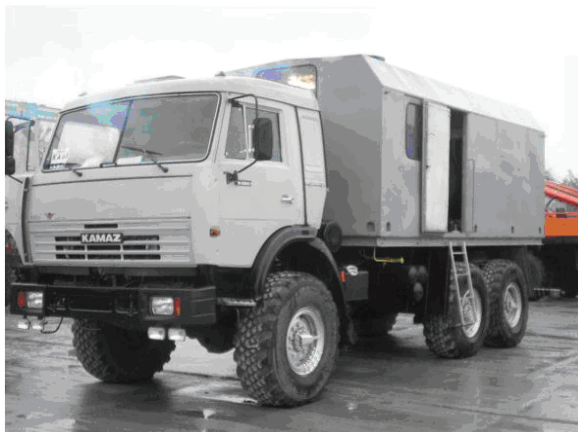
Рисунок 1. Общий вид установки промышленной паровой ППУА - 1600 / 100
