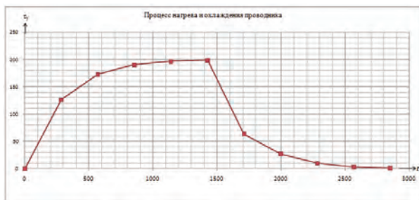
Рисунок 2 - Процесс изменения температуры проводника
