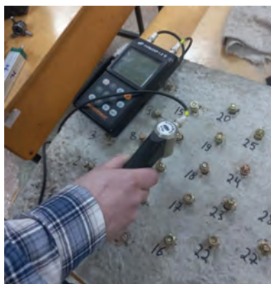
Рисунок 1. Замеры скорости прохождения УЗ волны
