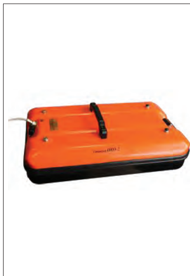
Рисунок 1 – Антенный блок АБ - 250М, применённый для сканирования грунтов
