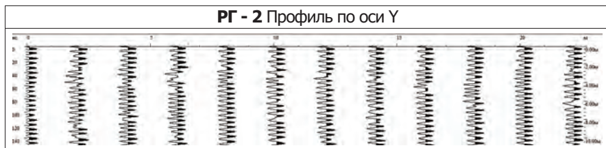
Рисунок 3 – Радарограммы грунтового массива здания
