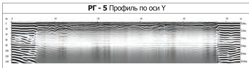
Рисунок 3 – Радарограмма грунтового массива между строениями
