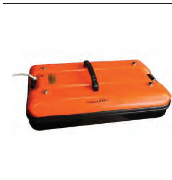
Рисунок 1 – Антенный блок АБ - 250М, применённый для сканирования грунтов
