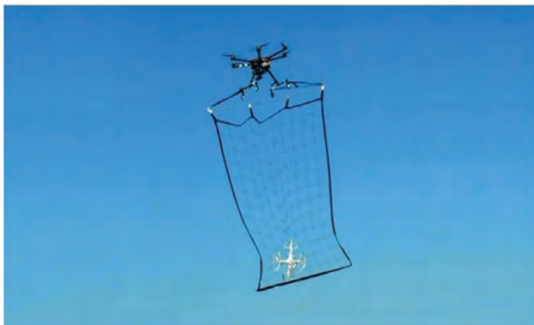
Рисунок 2 - Использование БПЛА – перехватчиков оборудованных сетью [7]
