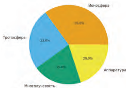
Рисунок 1 — Влияние различных факторов на точность GNSS.
