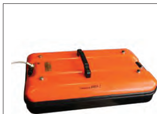
Рисунок 1 – Антенный блок АБ - 250М, примененный для сканирования грунтов
