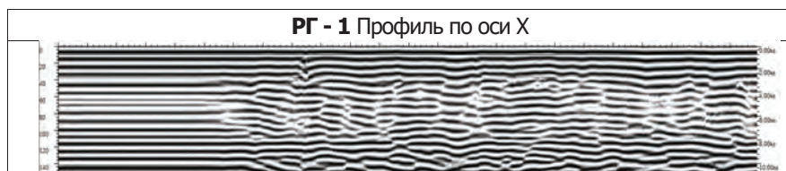
Рисунок 3 – Радарограмма грунтового массива здания по оси X
