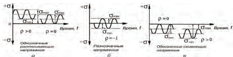
Рис. 2 – Виды вибрационного нагружения при различных видах силовых воздействий
