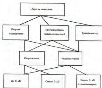
Рисунок 2 – Классификация систем зажигания по ГОСТ 1 02542 – 85
