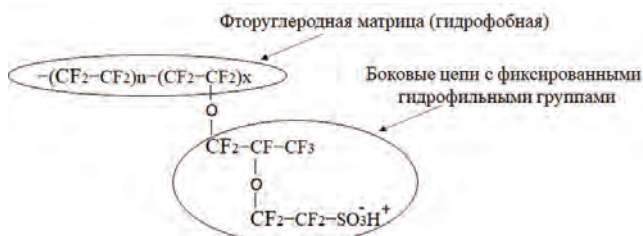
Рисунок 1 – Структура элементарного звена перфторированной сульфокатионообменной мембраны МФ - 4СК
