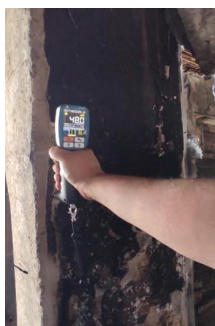
Рисунок 2 – Определение прочности железобетонной колонны после пожара
