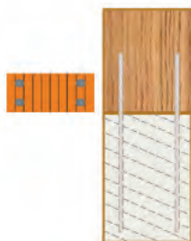
Рисунок 2 – Схема работы соединения на продольно клеенных стержнях
