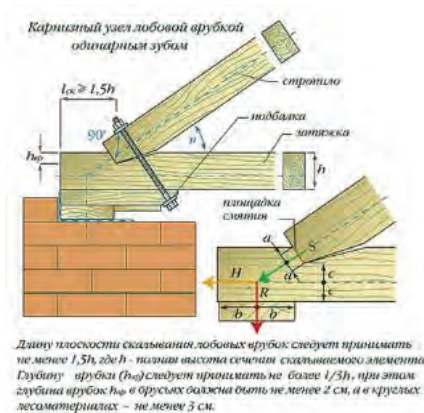
Рисунок 4 – Схема опорного узла треугольной брусовой малопроектной фермы для лобовой врубки
