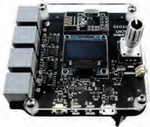
Рисунок 4. Система УЗ - навигации в помещении Geoscan «Локус»
