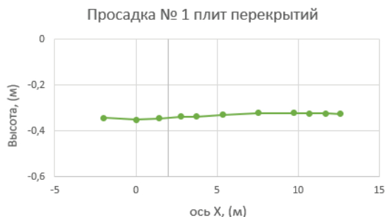
Рисунок 3 – Диаграмма просадки № 1 плит перекрытий
