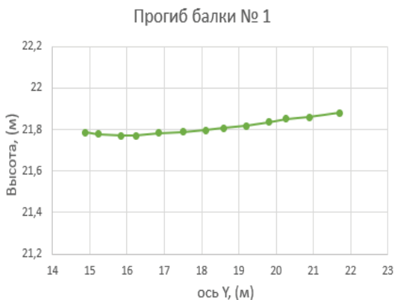
Рисунок 7.58. Диаграмма крена прогиба балки № 1 в подвале здания
