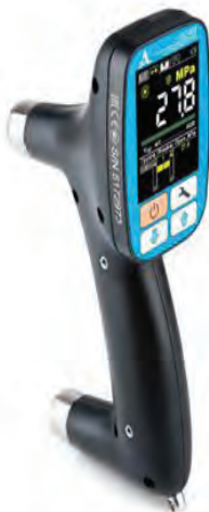
Фотография 1 - Ультразвуковой прибор «УК - 1401»
