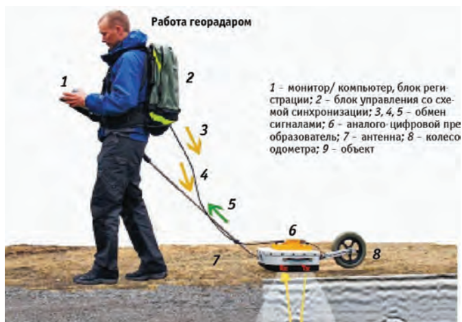
Рисунок 2. Пример работы с георадаром серии «ОКО»
