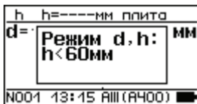
Рисунок 2. Пример дисплея при измерении диаметра арматуры
