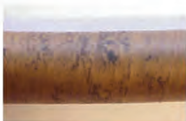
Рис.2. Следы частичного разряда в промежуточных слоях бумаги
