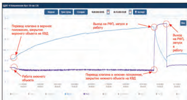
Рис.3. Кривая восстановления давления на скв. №136(комплексный подход) Fig. 3. The graph of pressure recovery at well № 136 (a comprehensive approach)
