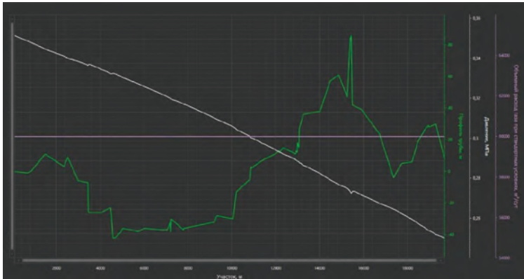
Рисунок 2 – Давление в газопроводе до запуска очистного устройства
