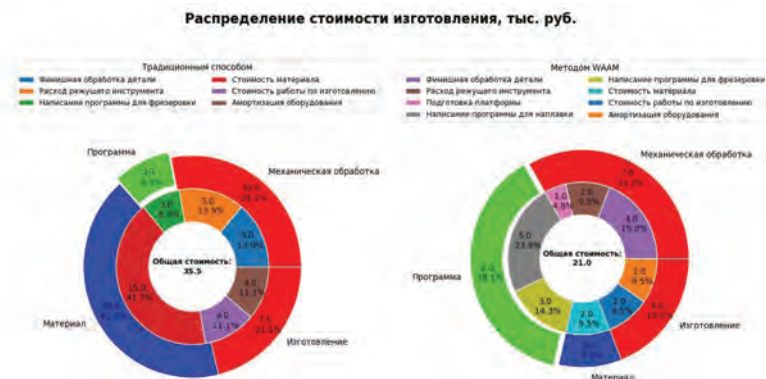
Рис. 2 Сравнение стоимости изготовления детали традиционным методом и аддитивным электродуговым выращиванием.
