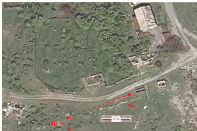
Рисунок 1 – Ситуационный план участка оползневого массива, где проводились геофизические исследования методом сейсморазведки.
