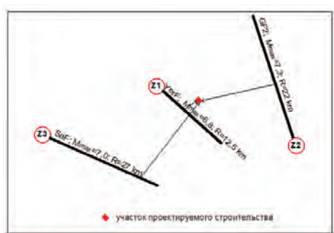
Рисунок 1 – Расчётная схема моделирования сценарных землетрясений
