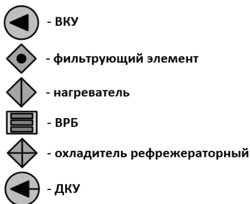
Рисунок 3 - Обозначения устройств технологической схемы МАУК
