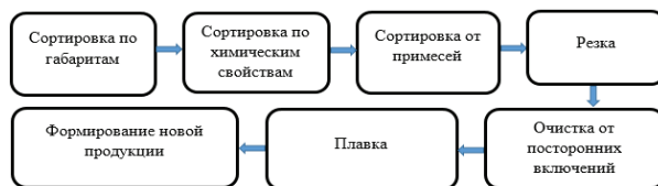
Рисунок 4. Процесс переработки лома металлов.
