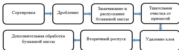
Рисунок 1. Процесс переработки бумаги и картона.
