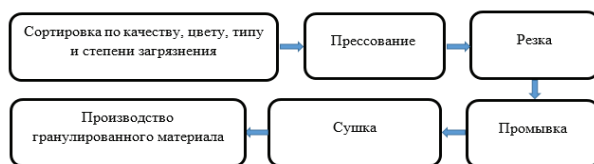
Рисунок 2. Процесс переработки пластиковых отходов.
