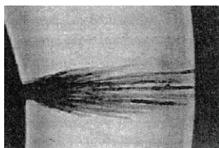
Рис. 5. Разросшийся водяной триинг в изоляции кабеля
