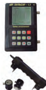
Рисунок 2 – Ультразвуковой прибор «Пульсар - 1.2»
