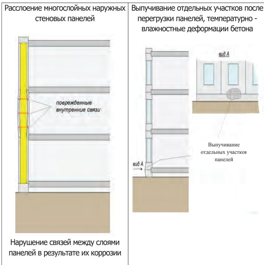
Каждая из перечисленных причин или их совместное действие может привести к разрушению железобетонной конструкции. Этот факт определяет сильную необходимость в проведении мероприятий по выявлению и устранению повреждений элементов конструкции. Таким образом, можно провести вывод, что каждый дефект конструкции нуждается в ликвидации, чтобы предотвратить разрушений конструкций из железобетона, а соответственно зданий.
