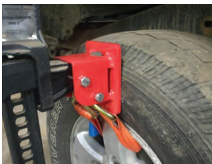
Рисунок 2 – Фото использования приспособления для вывешивания колеса
