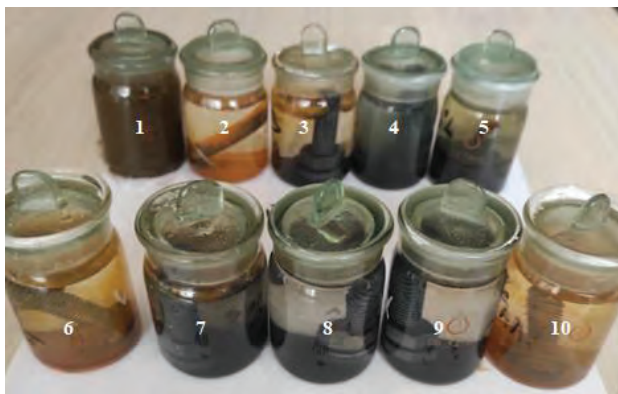
Рисунок 2.3 – Серия образцов для испытания на коррозионную стойкость:
