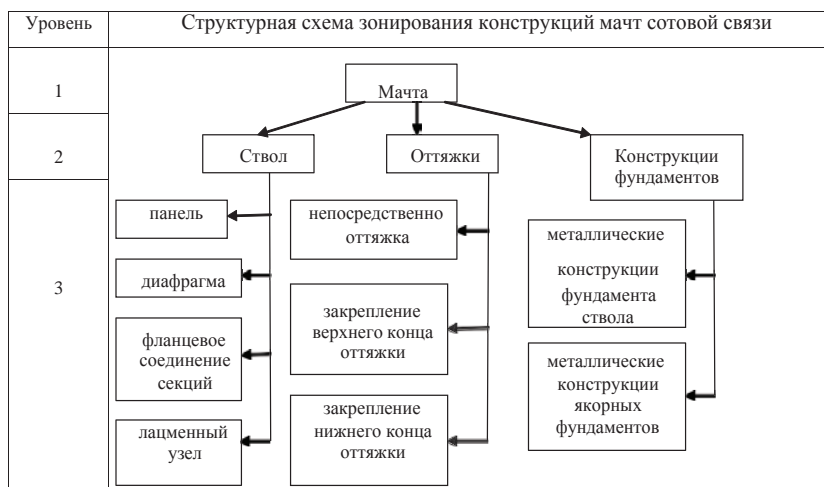
Рисунок 1. Структурная схема зонирования конструкций мачт сотовой связи.
